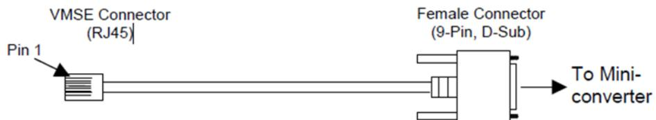
**Figure 26 Wiring Diagram**
