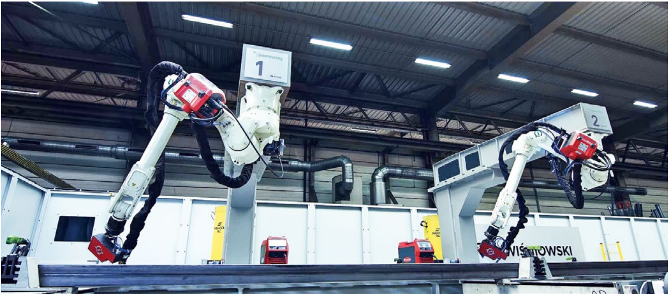
Stația de lucru ASTOR Green Welding - Roboți industriali Kawasaki
