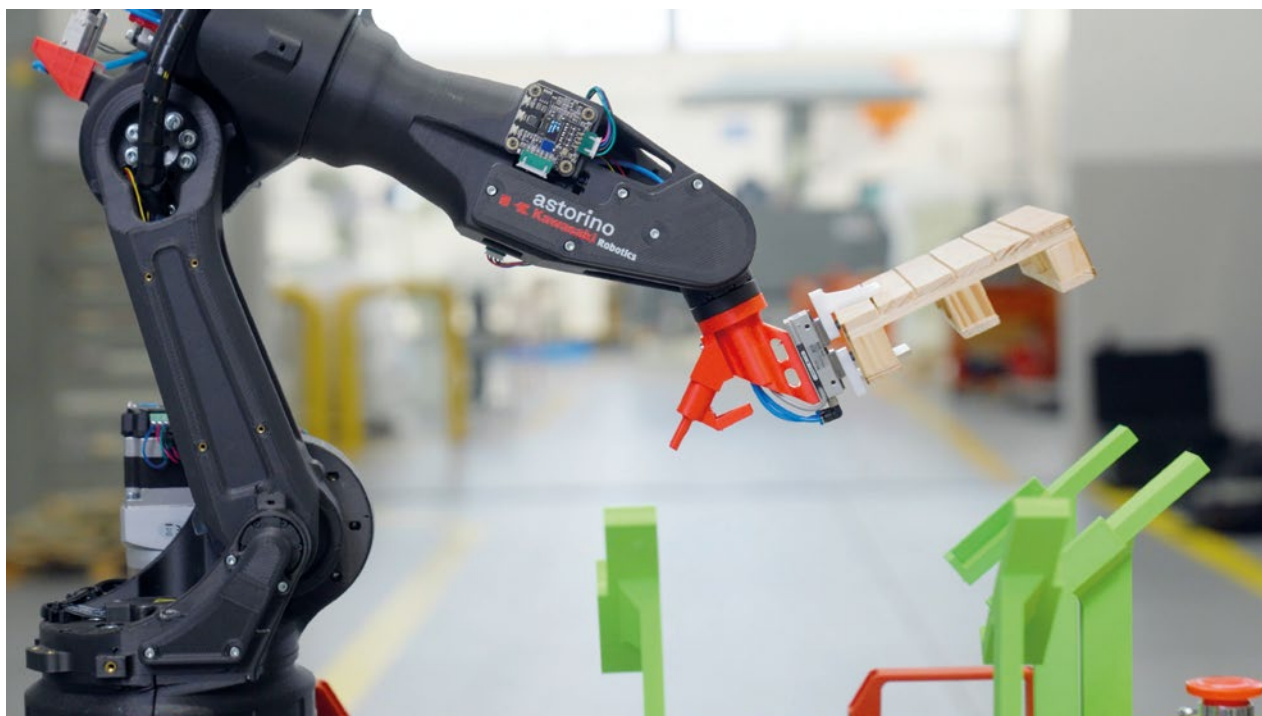
Robot Astorino w aplikacji symulacji zbijania i składowania palet (źródło: Tiesse Italia)
