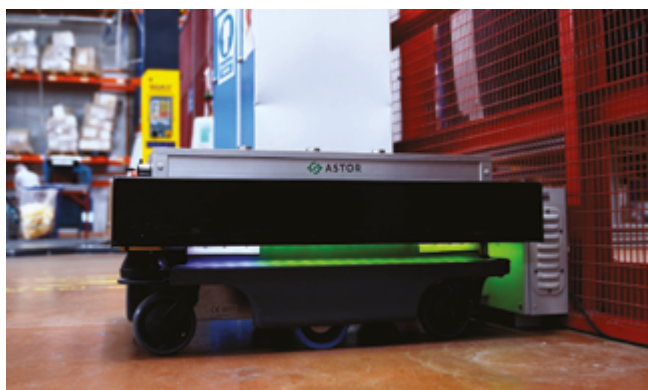
Robot MiR200 przy stacji ładującej
